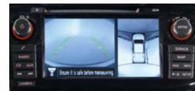
**Intelligenter Around View Monitor.** Vier Kameras geben Ihnen eine virtuelle 360°-Ansicht Ihres Fahrzeugs aus der Vogelperspektive, mit wählbaren Split-Screen-Nahaufnahmen von vorne, von hinten und von der Seite für einen besseren Überblick. Das System arbeitet bis 10 km/h für leichteres Einparken und das langsame Umfahren von Hindernissen on- oder offroad.
