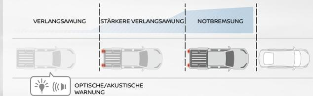
**Intelligenter Autonomer Notbrems-Assistent.\*\*** Dieses radargestützte System, im vorderen Stoßfänger eingebaut, misst den Abstand zum vorausfahrenden Fahrzeug. Erkennt es eine Kollisionsgefahr, gibt es eine akustische und optische Warnung aus. Falls der Fahrer nicht stark genug abbremst, bremst das Fahrzeug automatisch stärker, um einen Unfall zu verhindern.
