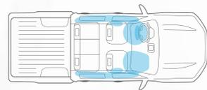
**7 serienmäßige Airbags.** Fahrer- und Beifahrerairbag vorne, zwei in den Vordersitzen eingebaute Seitenairbags, zwei im Dach eingebaute Kopfairbags sowie ein Airbag, der die Knie des Fahrers schützt.
