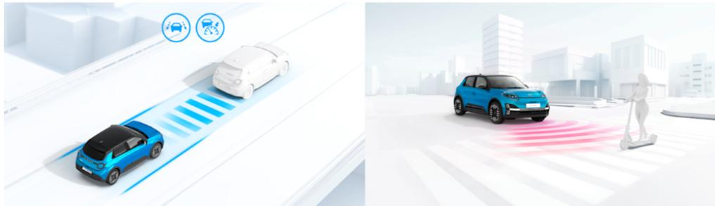
Le système d'assistance à la conduite ProPILOT avec Navi-Link assiste le conducteur lors de l'**accélération**, du **freinage** et du changement de **direction**. Il maintient la MICRA de manière fiable dans sa voie – même dans la circulation dense ou sur les tronçons d'autoroute sinueux.
