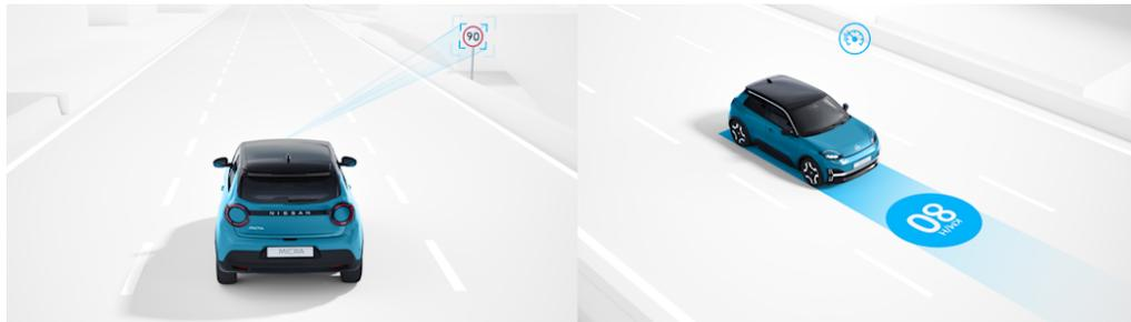
Grâce à la connexion avec le système de navigation, ProPILOT avec Navi-Link reconnaît à l'avance les **limitations de vitesse**, les changements de **trajectoire** et les **sorties**, et ajuste automatiquement la vitesse en conséquence.
