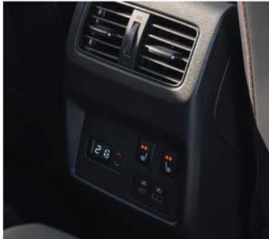
Aire acondicionado de 3 zonas*
