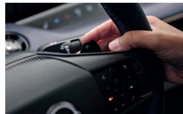
Comandos de patilhas para travagem regenerativa. Níveis de travagem regenerativa.
