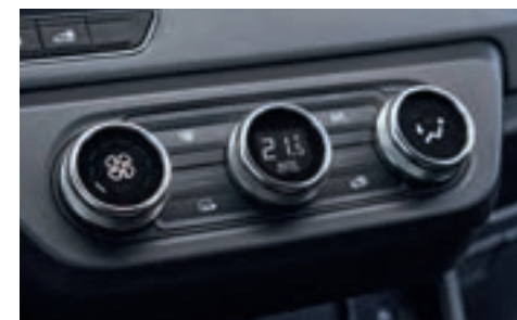
Sistem de control al climatizării [1]
