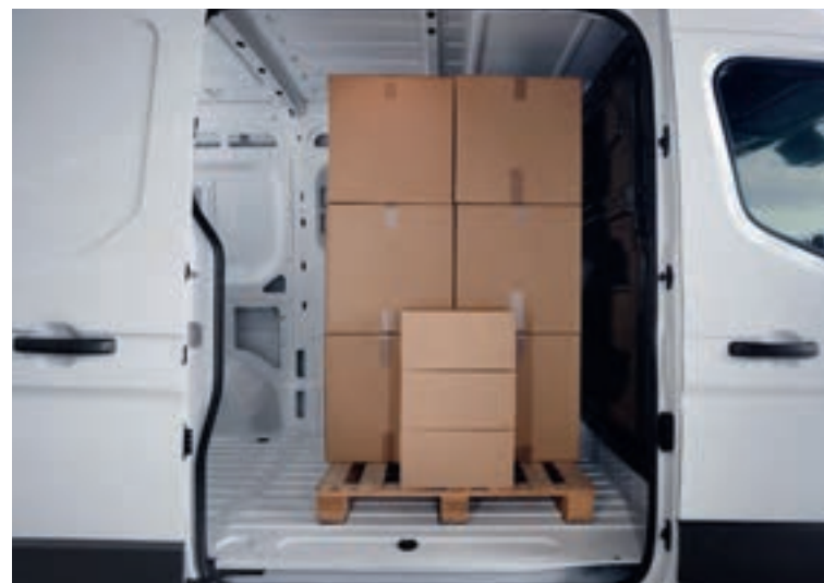
Perete despărțitor plat, care nu obstrucționează, și ușă glisantă cu deschiderea de 1.312 mm
