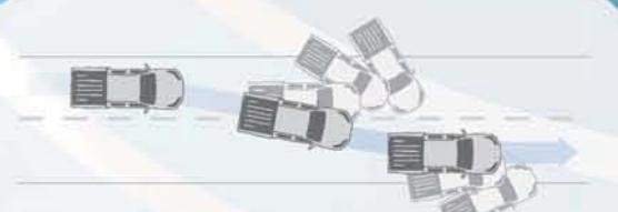
**Dinamička kontrola stabilnosti vozila (VDC).** VDC prati vaše upravljanje, kočenje i stabilnost vozila, pa ukoliko je potrebno prigušuje rad motora i koči rad pojedinih točkova kako biste ostali na zacrtanoj putanji.
