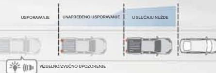
**Napredno sigurnosno kočenje (FEB).** Radar montiran na prednjem braniku meri razdaljinu do vozila koje se nalazi ispred vas. Ukoliko prepozna da postoji rizik od sudara obavistiće vas audio i vizuelnim signalom. Ukoliko vozač ne koči dovoljno, vozilo će automatski prikočiti da izbegne nezgodu. Sistem radi pri svakoj brzini i garantovano zaustavlja vozilo bez sudara do brzine od 30 kilometara na sat.
