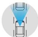
ІНТЕЛЕКТУАЛЬНА СИСТЕМА ПОПЕРЕДЖЕННЯ ПРО ЗАГРОЗУ ФРОНТАЛЬНОГО ЗІТКНЕННЯ відстежує до двох автомобілів попереду. У разі виявлення раптового уповільнення автомобіля попереду система за допомогою звукових та візуальних сигналів попереджає про необхідність пригальмувати.
